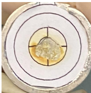
Рис. 1. Вид прожжённого индикатора из бумаги после проведения burn test
