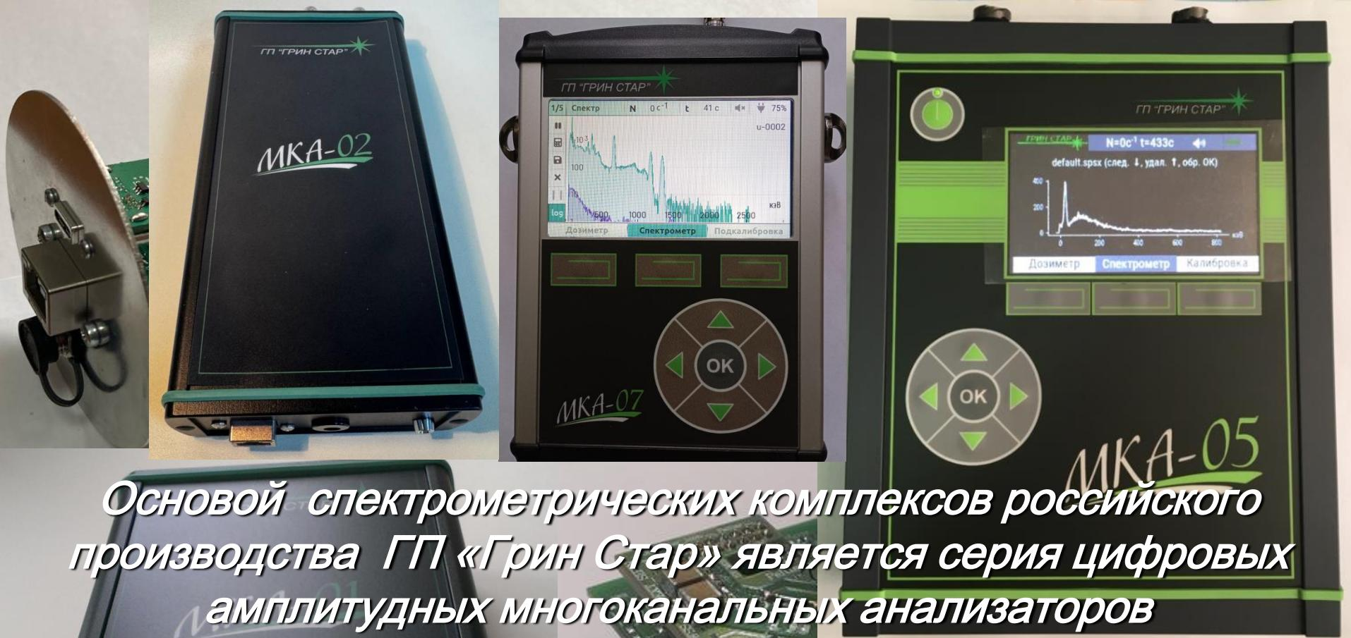
*Основой спектрометрических комплексов российского производства ГП «Грин Стар» является серия цифровых амплитудных многоканальных анализаторов типа МКА-01, 02, 05, 07...*
